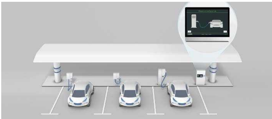
Typischer Ladepark mit zentralem Touch-Terminal zur Nutzerführung und -autorisierung
